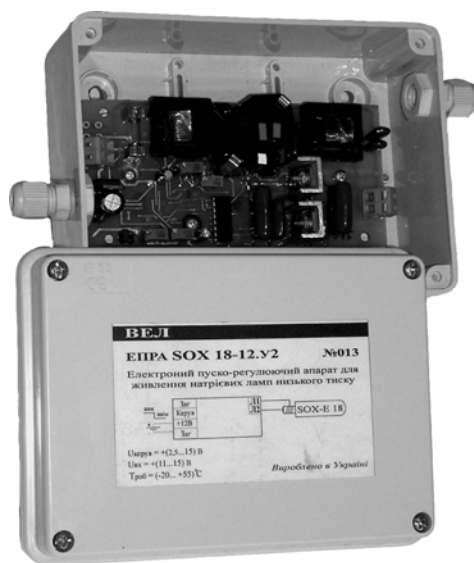
Рис. 3 Пускорегулирующий аппарат ЭПРА SOX-E
