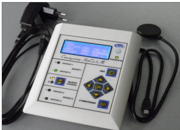
Рис. 4. Зовнішній пульт керування з телеметричною антеною.
