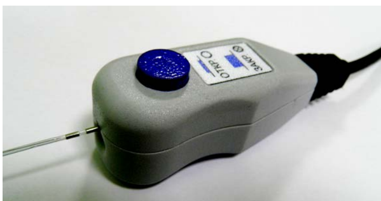
Рис. 4.3. Блок контактирования и электрод диаметром 1,2мм. Слева - проксимальная часть цилиндрического электрода Справа - блок контактирования.
